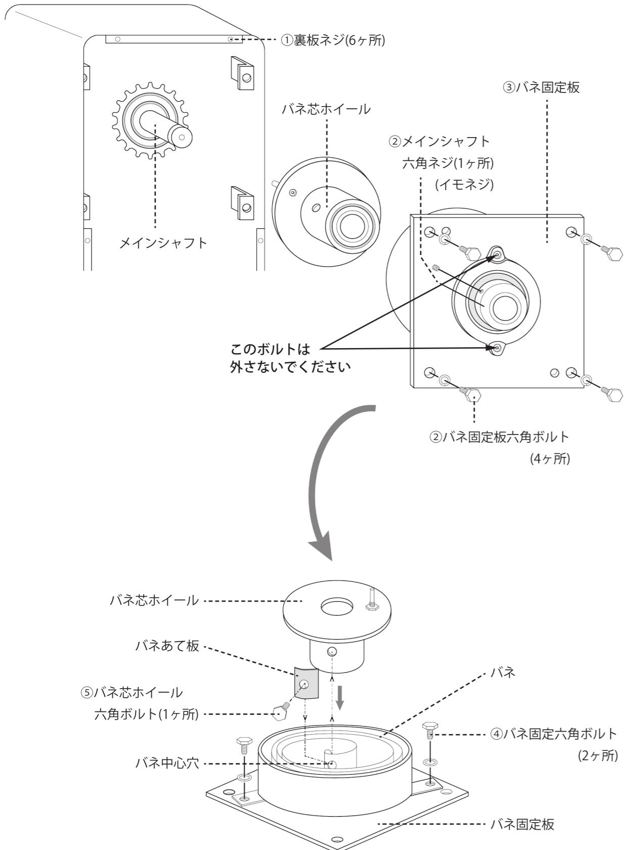
使用工具：Ⓐ + ドライバー、Ⓑ 六角レンチ (2.5mm)、Ⓒ ボックスドライバー (10mm)、Ⓓ スパナ (14mm)、Ⓔ ハンマー
