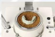
模型に高さやアンダーカットがある場合は専用の砂の中に模型を設置して製作します。
