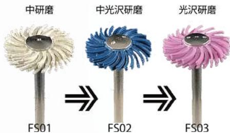
○柔軟性のある樹脂製ブラシで風を巻き込む形状のため、研磨熱の発生を抑える事ができます。低速にて3段階の研磨を行う事で次の仕上げ工程で楽に光沢研磨が可能です。
